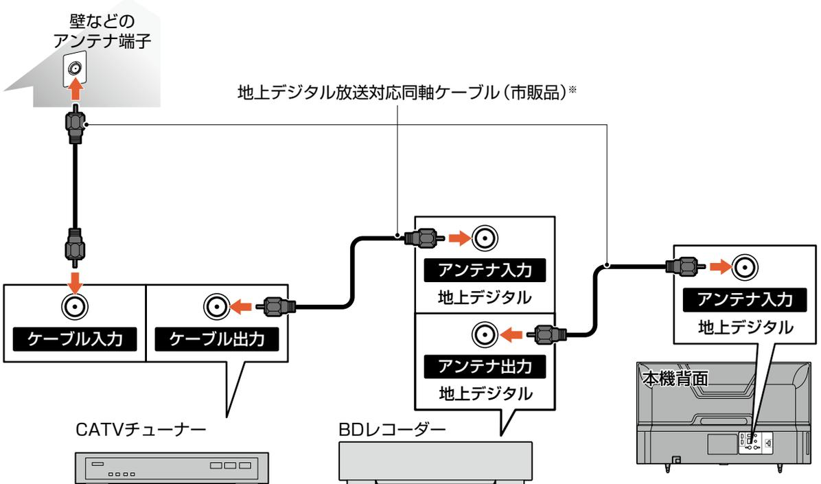
※ シールド性能が高いものをご使用ください。シールド性能が低いものでは、周囲のノイズの影響により受信性能が悪化する場合があります。
