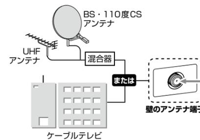
2 アンテナ端子と分波器を同軸ケーブルでつなぎます。
