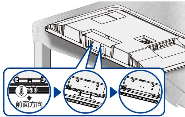
③ スタンド取付ネジ(M4×20 mm)を3箇所のネジ穴に、プラスドライバー(市販品: JIS2番/直径6 mm)でしっかりと締める
