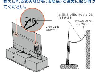
本機を再び移動させるときは、ネジやひもをはずしてから ご注意 移動させてください ネジ、ひもなどの取り付けは確実におこなってください。
